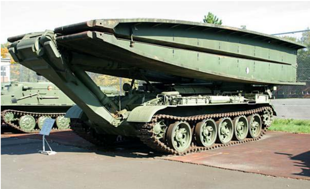
Abb. 10 : Brückenlegepanzer BLG-60-M der NVA
